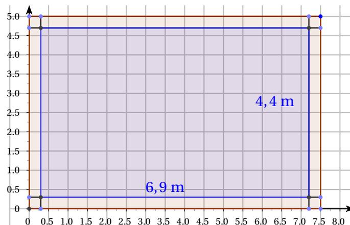
Les panneaux doivent être accolés les uns aux autres et une bordure d'au moins 30 cm de large (soit 0,3 m) doit être laissée libre. Donc on cherche à installer les 20 panneaux dans un rectangle de côtés 6,9 m et 4,4 m (en bleu sur le dessin) puisque :
